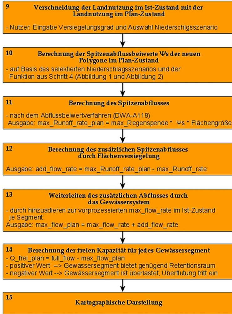
Abbildung 4: Ermittlung von Durchflusskapazitäten für das PROSPER-RO Gebiet im Plan-Zustand (orange: Nutzung von QGIS/Python)
